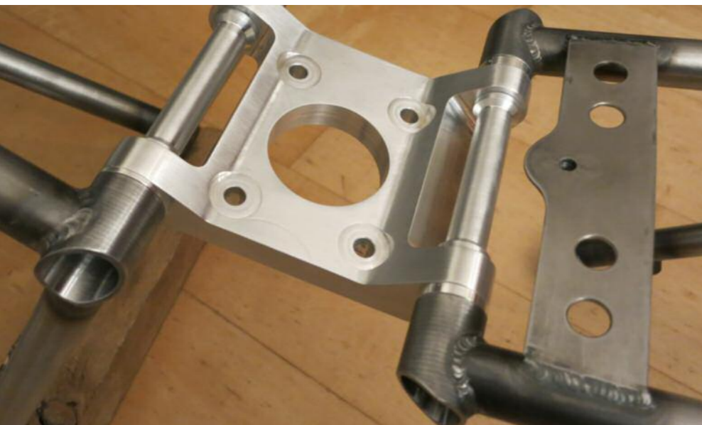
Zentrales Bauteil bei der auf das Wesentliche reduzierten Rahmenbauform ist die Leichtmetall-Verbindungsplatte von Front- und Heckrahmenteil. Die Platte wird direkt mit dem Zylinderkopf verschraubt. Das Foto in der Mitte zeigt Harald Reitprecht am Gasgriff beim Warmlaufenlassen des Motors am Slovakiaring. Karl Rappersberger behält den Drehzahlmesser kritisch im Auge. Im Hintergrund wartet Fahrer Robert Gut auf seinen Einsatz. Der durfte dann das spärlich bestückte Cockpit im Auge behalten. Bis 11 000/min kann der 350er Pantah-Twin gezwibelt werden
