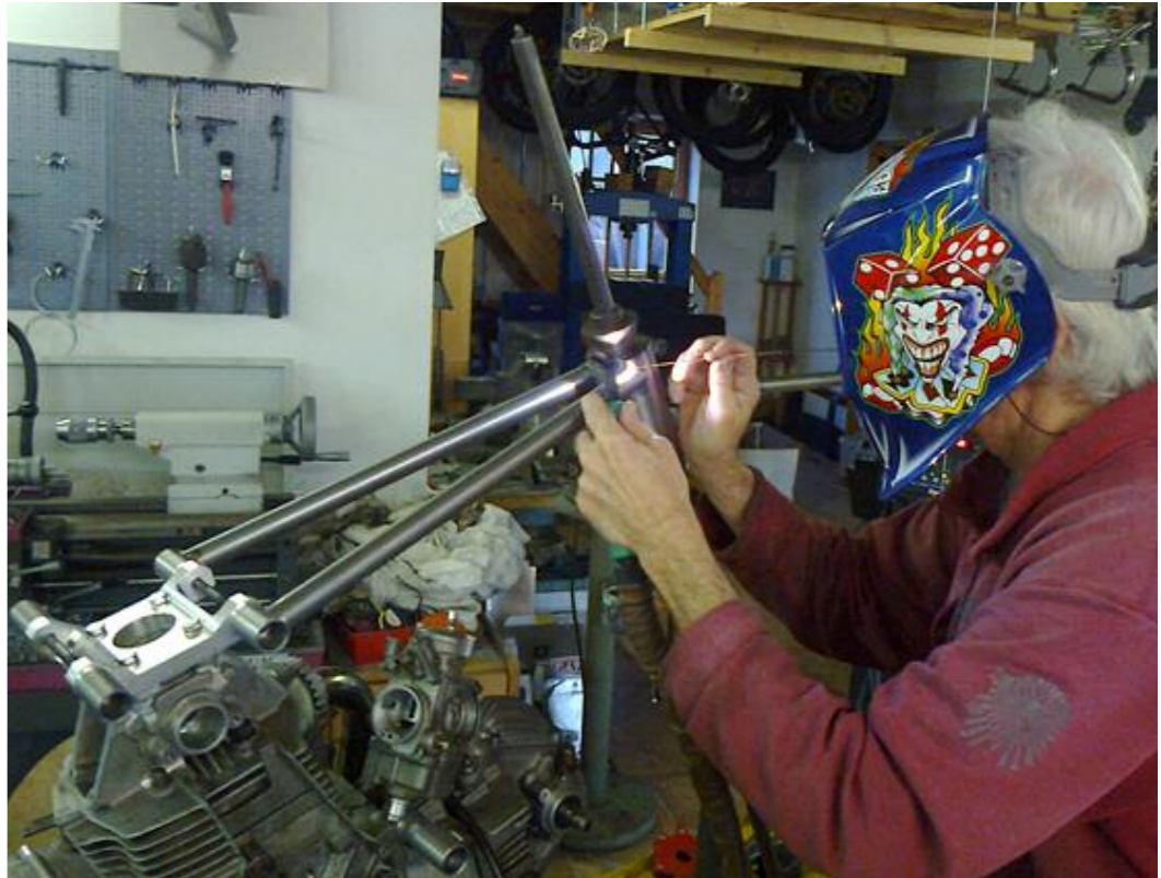
Im Spannungsfeld. Harald Reitprecht lässt sein Miller Dynasty-Schweißgerät im WIG-Verfahren ein Lied singen
