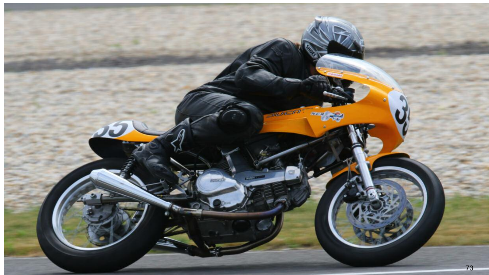
Für den Verbundrahmen wurde nahtlos gezogenes Präzisions-Stahlrohr vom Typ E 235/1.0308+C verwendet. Als Schweißgut kam MT-WSG 2 zum Einsatz. Harald Reitprecht fügte das Konstrukt mit einem Schweißgerät Miller Dynasty 350 im so genannten WIG-Verfahren. Das heißt, eine Wolfram-Elektrode bringt den Werkstoff unter Schutzgas in flüssigen Zustand. Das Schweißgut wird dann wie beim traditionellen Autogen-Verfahren per Hand mit Gefühl und Könnerschaft zugeführt. Heraus springt im Idealfall nicht nur ein dauerhaft und stabil gefügter Rahmen, sondern auch höchst ansehnliche, weil besonders fein ziselierte Schweißnähte. Deshalb wird das WIG-Schweißverfahren gerne dort eingesetzt, wo es auf besondere Präzision und Kontrolle beim Fügen ankommt. Etwa dann, wenn dünnwandige Rohre zum Einsatz kommen. Den ersten Einsatz bei einer Rennveranstaltung erlebte die Ducati Pantah 350 RR im Rahmen einer Grab the Flag-Veranstaltung auf dem Slovakiaring in der Slowakei nahe Bratislava. Fahrer Robert Gut kam mit dem Eigenbau auf Anhieb blendend zurecht. Am Ende sprangen der zweite Platz und die schnellste Rennrunde heraus. In der Klasse treffen Ducati Pantah, Moto Morini und auch Yamaha XS 360 in mehr oder weniger umfangreich getunter Verfassung aufeinander
