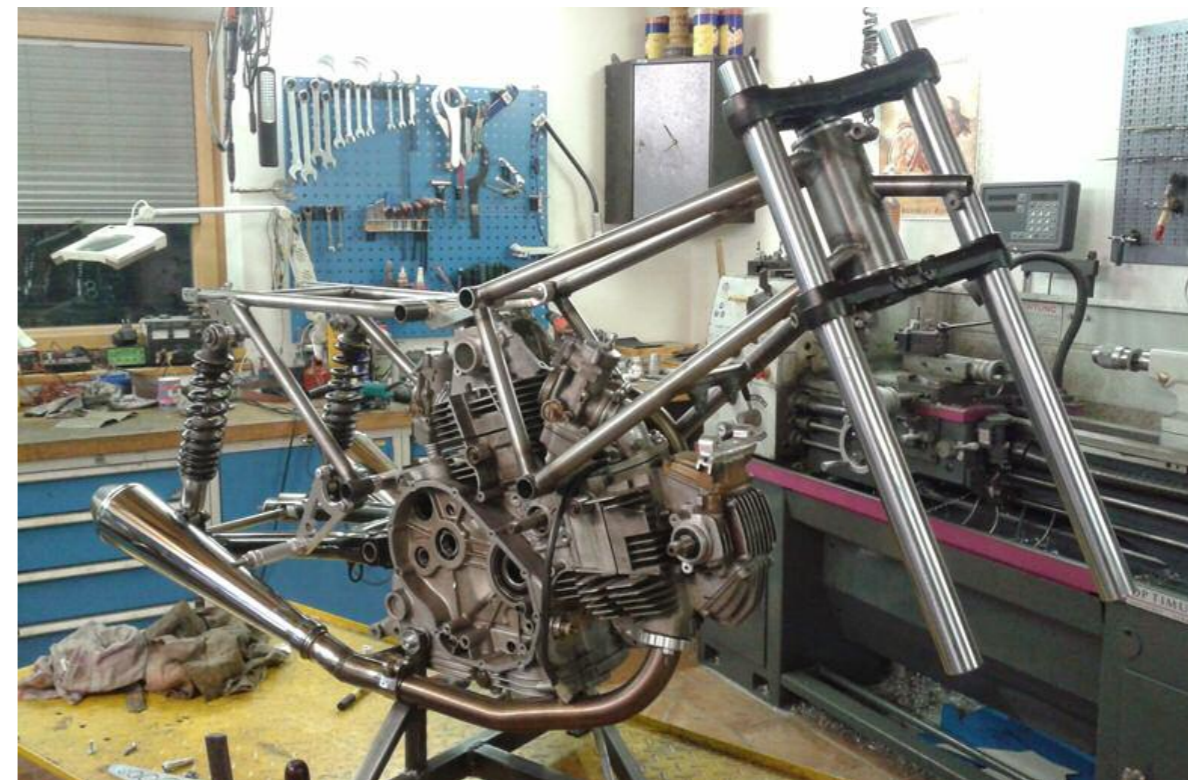
Für den Verbundrahmen wurde nahtlos gezogenes Präzisions-Stahlrohr vom Typ E 235/1.0308+C verwendet. Als Schweißgut kam MT-WSG 2 zum Einsatz. Harald Reitprecht fügte das Konstrukt mit einem Schweißgerät Miller Dynasty 350 im so genannten WIG-Verfahren. Das heißt, eine Wolfram-Elektrode bringt den Werkstoff unter Schutzgas in flüssigen Zustand. Das Schweißgut wird dann wie beim traditionellen Autogen-Verfahren per Hand mit Gefühl und Könnerschaft zugeführt. Heraus springt im Idealfall nicht nur ein dauerhaft und stabil gefügter Rahmen, sondern auch höchst ansehnliche, weil besonders fein ziselierte Schweißnähte. Deshalb wird das WIG-Schweißverfahren gerne dort eingesetzt, wo es auf besondere Präzision und Kontrolle beim Fügen ankommt. Etwa dann, wenn dünnwandige Rohre zum Einsatz kommen. Den ersten Einsatz bei einer Rennveranstaltung erlebte die Ducati Pantah 350 RR im Rahmen einer Grab the Flag-Veranstaltung auf dem Slovakiaring in der Slowakei nahe Bratislava. Fahrer Robert Gut kam mit dem Eigenbau auf Anhieb blendend zurecht. Am Ende sprangen der zweite Platz und die schnellste Rennrunde heraus. In der Klasse treffen Ducati Pantah, Moto Morini und auch Yamaha XS 360 in mehr oder weniger umfangreich getunter Verfassung aufeinander
