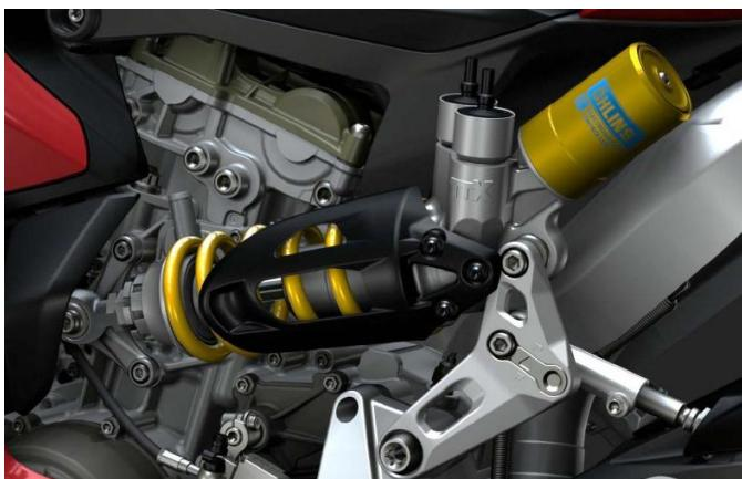
Konstrukteure nennen hierbei die besseren Traktion als großen Vorteil dieser Maßnahme. Die Abstützung übernimmt ein seitlich montiertes Federbein samt Ohlins TTX - Dämpfer. Die Hebelwirkung kann recht einfach im Linkage - System von Progressiv auf Flat, also Wettbewerbserfordernisse, gewechselt werden. Die Zug- und Druckeinstellungen lassen sich genauso wie bei der 43 mm Ohlins NIX30 USD - Gabel auch während der Fahrt mit Hilfe kleiner Servomotoren einstellen.
